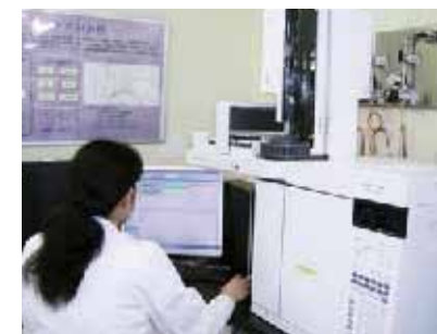
◇GC-FID(水素炎イオン化型検出器付ガスクロマトグラフ)
