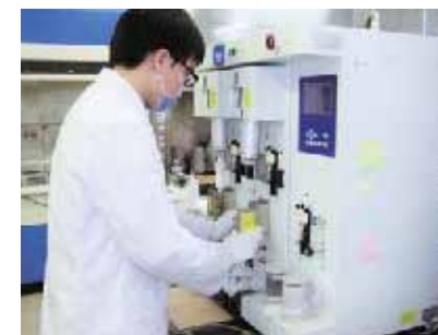
◇ダイオキシン類自動前処理装置
