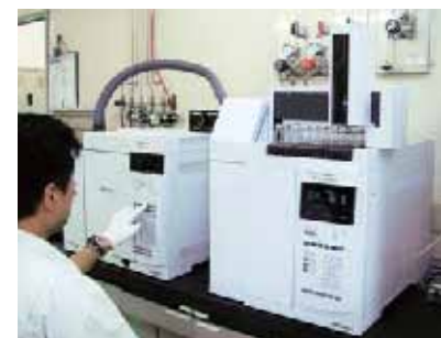
◇ヘッドスペースサンプラー付ガスクロマトグラフ
